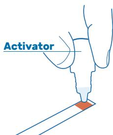
Befeuchten Sie das Pad, indem Sie kurz das Aktivatorfläschchen an das Pad halten. Der Activator fließt selbständig aus. Der rote Farbstoff wird aktiviert und bleibt für etwa 15 Minuten aktiv.
