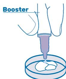
Bei allen nitroaromatischen Sprengstoffen kommt es zu einem sofortigen Farbumschlag. **Sie benötigen kein Teststäbchen.**
