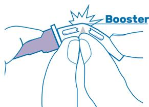
Biegen Sie die Tropfflasche, um die Glasampulle darin zu zerbrechen. Der Booster kann nun bis zu zwei Stunden verwendet werden. Geben Sie einen Tropfen des Boosters auf die zu untersuchende Substanz.
