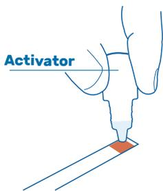
Befeuchten Sie das Pad, indem Sie kurz das Aktivatorfläschchen an das Pad halten. Der Activator fließt selbständig aus. Der rote Farbstoff wird aktiviert und bleibt für etwa 15 Minuten aktiv.
